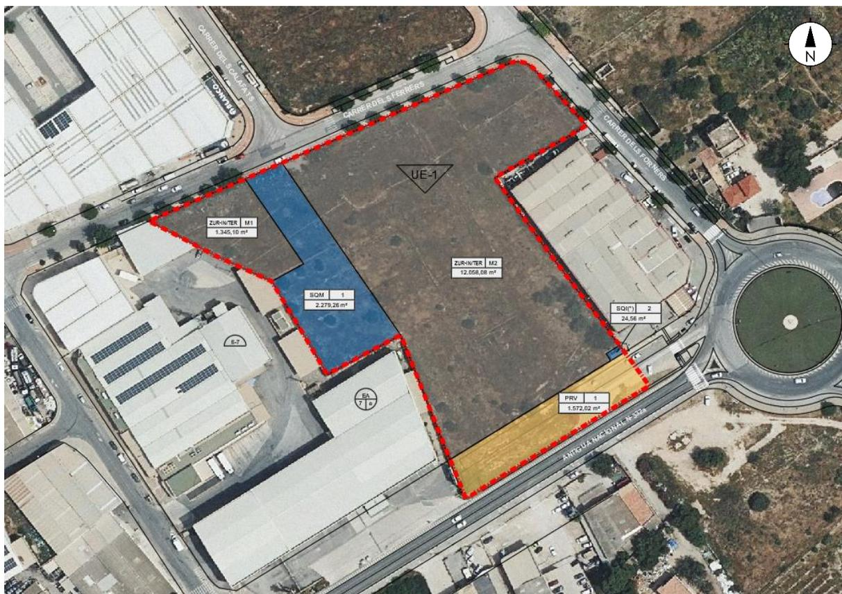
**Alternativa 3:** Eliminación del vial de red secundaria y su reemplazo por un equipamiento situado el extremo oeste de la Unidad de Ejecución.
